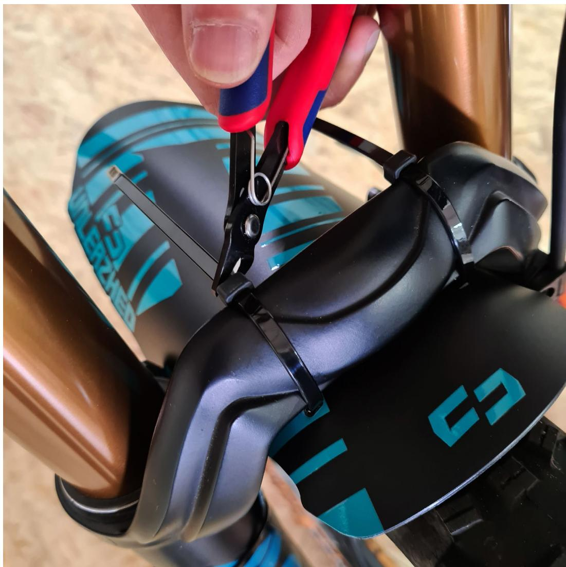
**Montaje de nuestro UNSPLASH M01 en tu horquilla de suspensión con el puente de horquilla orientado hacia atrás**
